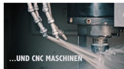
モジュラー式クーラントホース。8.0 MPa 対応。優れたクーラントの直進性を発揮。クーラントの安定供給が加工の安定につながります。スイス製。
