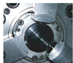
調節ねじで 10 mm まで微調整が可能。適当なダミーを探す手間が省けます。
