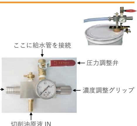
水の圧力により水溶性切削原液を最適濃度に希釈できる省力機器
